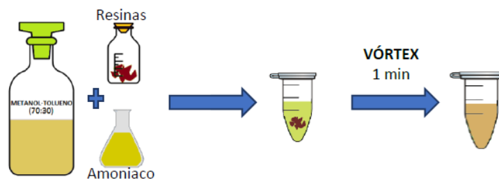
Figura 18. Preparación de la muestra a analizar por ESI FT-ICR MS (negativo).
