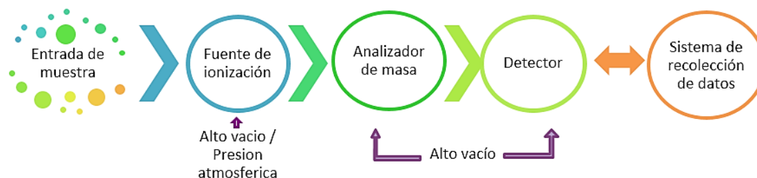
Figura 4. Esquema general de un espectrómetro de masas
