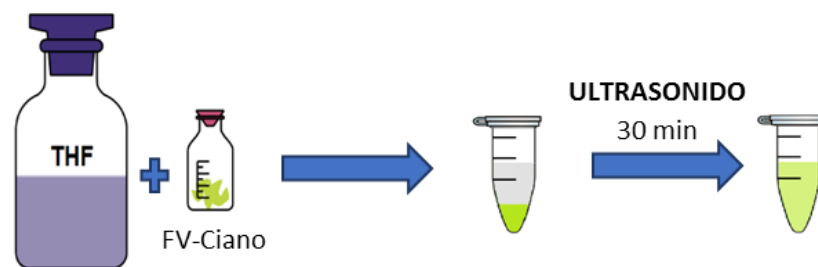
Figura 13. Esquema de la preparación de la solución de la matriz para MALDI.
