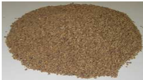
Figura 5B. Lecho filtrante (cascarilla de palma africana)
