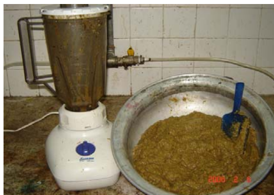
Figura 2.5 Licuadora para reducción de tamaño de partícula entre 2-3 mm (Etapa 3)
