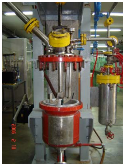
Figura 2.6 Reactor Batch para hidrólisis térmica catalizada con chaqueta de calentamiento. Capacidad 20 L
