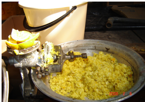
Figura 2.4 Molino para reducción de tamaño de partícula a 6 mm (Etapa 2)
