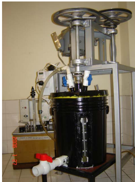
Figura 2.7 Reactor Batch de fermentación con serpentín para calentamiento. Capacidad 20 L.
