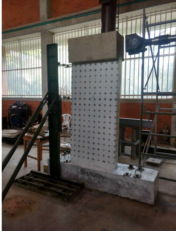
Figura 10: Detalle de cuadrícula para medir agrietamientos y deformaciones del muro experimental.
