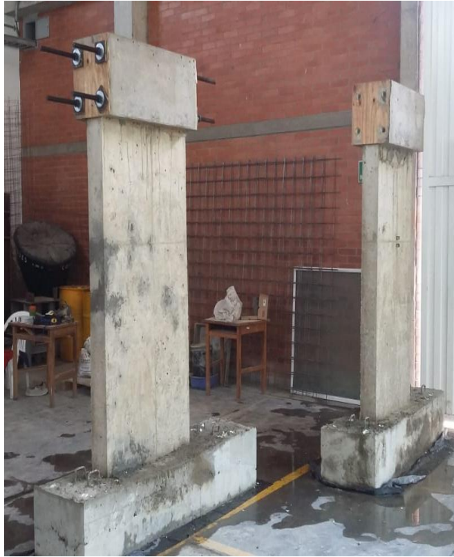
Figura 9: Muros (02) experimentales construidos.
