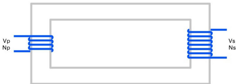
Figura 9. Modelización de un transformador elevador
