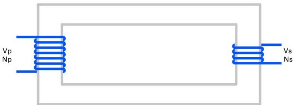
Figura 7. Modelización de un transformador monofásico ideal
