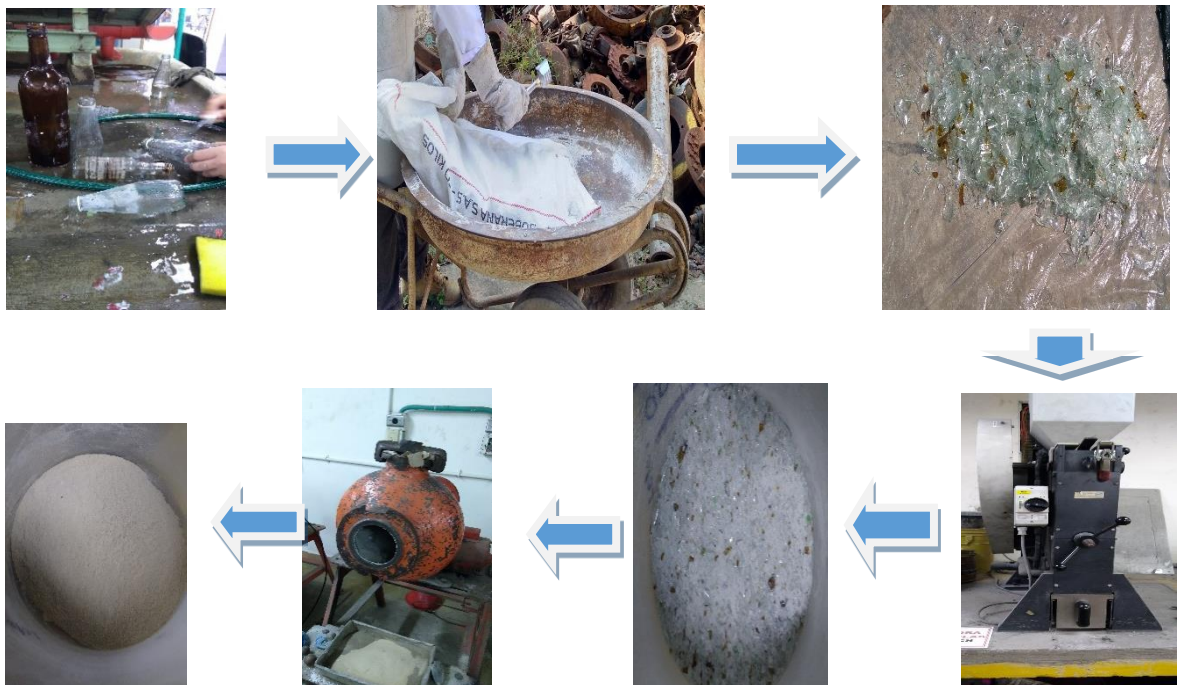
Figura 5 : Proceso de transformación del residuo de vidrio
