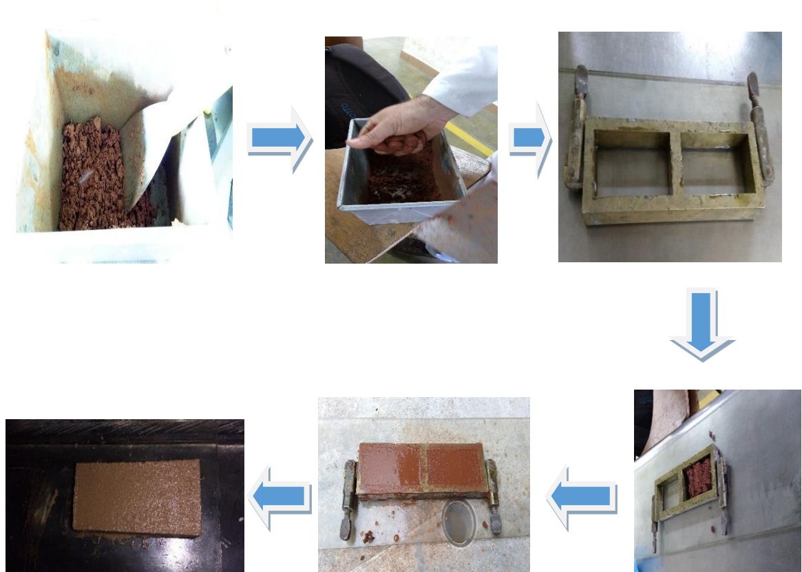
Figura 7 : Proceso de compactación de la mezcla en el molde
