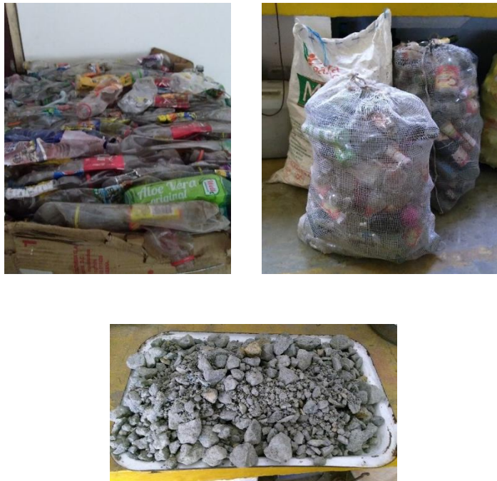
Figura 3 : Materia prima empleada en la fabricación de los ladrillos (residuos mineros y componentes de basura doméstica)
