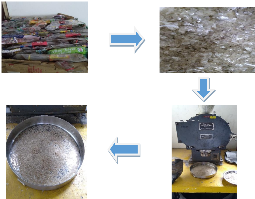
Figura 4 : Proceso de transformación del residuo de plástico
