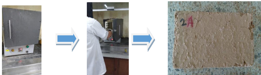
Figura 11 : Procedimiento del ensayo de choque térmico realizado a los ladrillos
