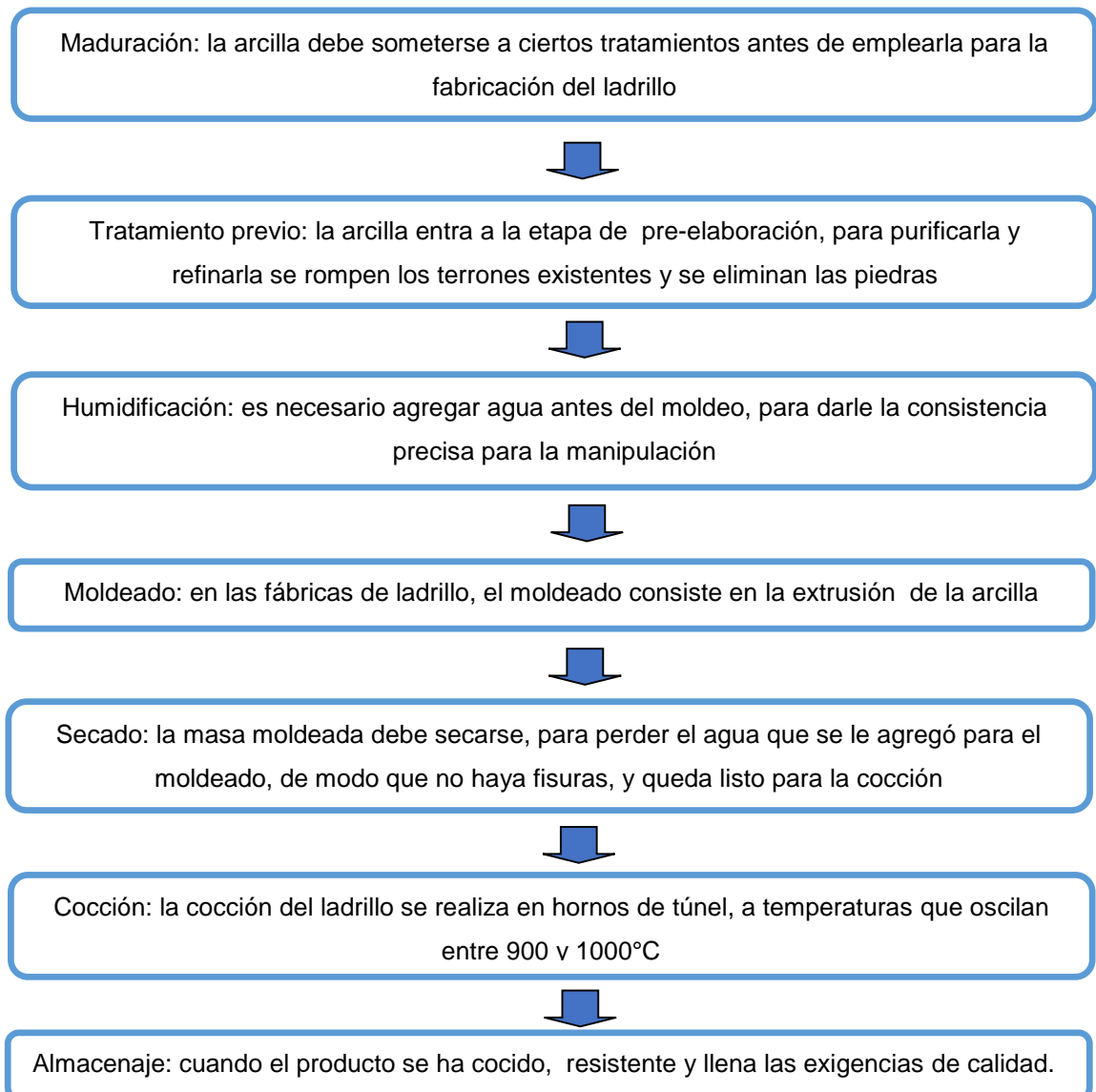
Figura 1: Proceso de producción de un ladrillo convencional
