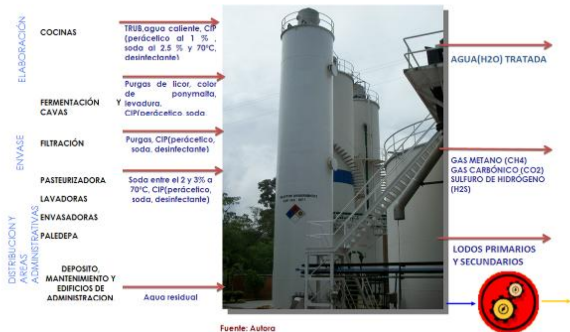
Figura 6. Esquema de entradas y salidas del proceso de la PTAR
