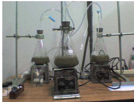
Figura 5. Montaje de las fermentaciones anaerobias.
