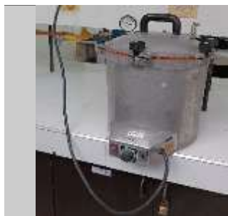
Montaje de la autoclave.
