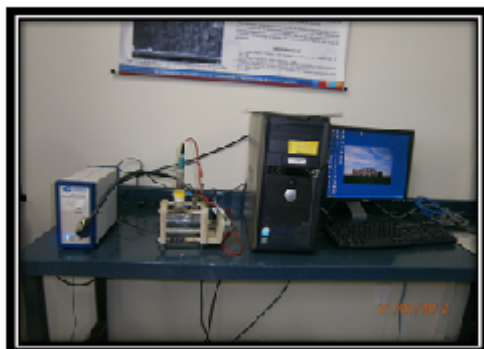
Figura 9. (a) Equipoutilizado en el desarrollo de las pruebas electroquímicas, (b) celda electroquímica
