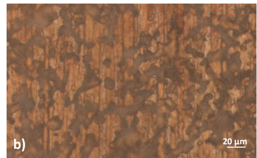
Figura 16 Microestructura de la muestra \text{SiO}_2\text{-APTES (APA}_7\text{/PAH}_9\text{)}_{125} a) burbujas presentes en el ensamble b) burbujas presentes en el ensamble aumentado 10x.
