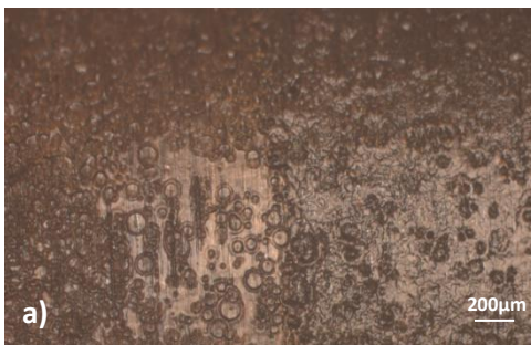
Figura 16 Microestructura de la muestra \text{SiO}_2\text{-APTES (APA}_7\text{/PAH}_9\text{)}_{125} a) burbujas presentes en el ensamble b) burbujas presentes en el ensamble aumentado 10x.
