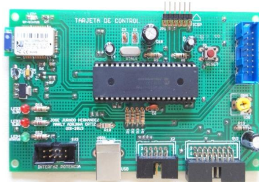
Figura 11. Tarjeta de control
