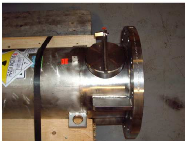
Fuentes radiactivas de Co-60 empacadas en su blindaje original para el transporte
