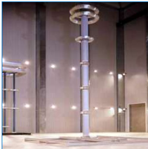
Figura 47. Pararrayo en porcelana para aplicaciones HVDC de 800 kV.
