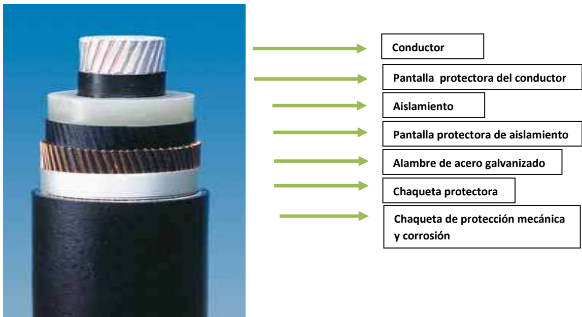
Figura 32. Sección transversal cable HVDC [ABB HVDC cable].
