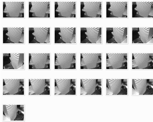
Figura 34. Secuencia de imágenes desplazadas cada 5° para calcular el eje de rotación en la cámara 1.
