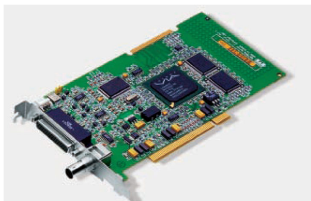
Figura 14. Tarjeta Matrox Meteor II
