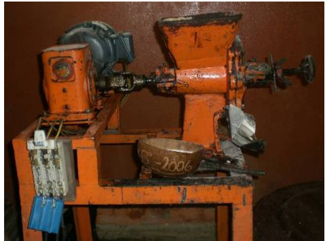
Foto 18. Máquina moledora de cacao. Todo el proceso se hace de manera artesanal
