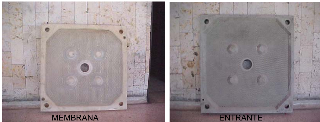
Figura 3. Dos de las 37placas que conforman el Filtro Prensa (Fotografía tomada en Bavaria S.A Cervecería de Boyacá)
