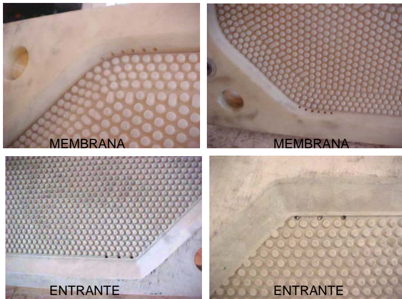
Figura 5. Orificios superiores e inferiores de placas de membrana y entrantes (Fotografía tomada en Bavaria S.A Cervecería de Boyacá)
