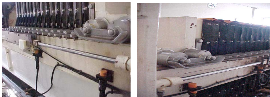
Figura 13. Detectores de proximidad tipo inductivos (Fotografía tomada en Bavaria S.A. Cervecería de Boyacá)
