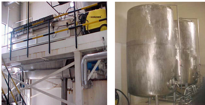
Figura 2. Filtro prensa cerrado y tanques de recuperación de cerveza cerrados (Fotografía tomada en Bavaria S.A Cervecería de Boyacá)
