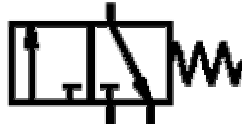
Figura 24. Válvula distribuidora 3/2, (entrada de aire) (Tomada de revista REEA, Revista de Electricidad, Electrónica y Automática)
