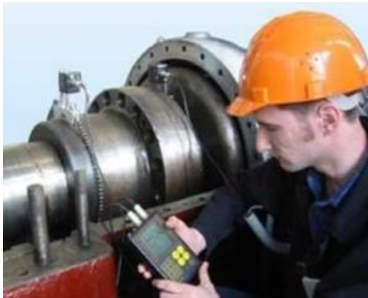
Figura 22: Toma de análisis de vibración por sistema de monitoreo en ruta
