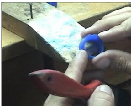
Figura 6. Limpieza y pulido de la cera. Fuente: Datos referencia 2.
