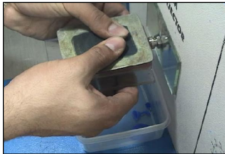
Figura 44. Inyección de la cera. Fuente: Datos referencia 2.
