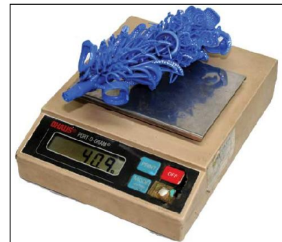
Figura 60. Pesaje del árbol. Fuente: Datos referencia 2.
