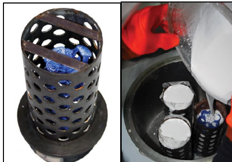
Figura 55. Soporte metálico y llenado del revestimiento. Fuente: Datos referencia 2.
