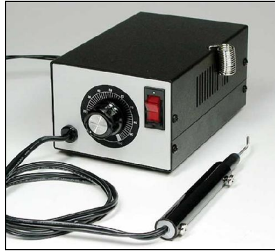
Figura 9. Cautín para joyería. Fuente: Datos referencia 2.
