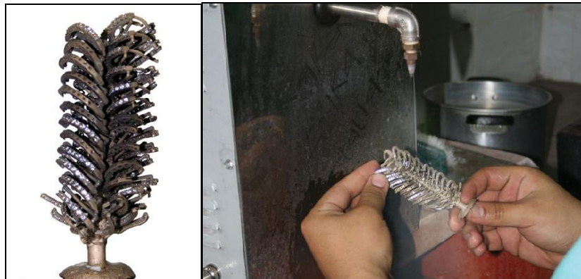
Figura 63. Árbol recién extraído y limpieza del árbol para aspersión. Fuente: Datos referencia 2.
