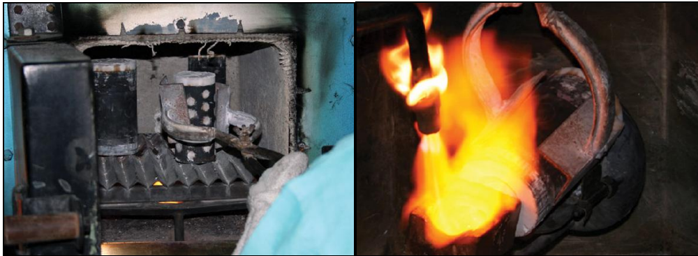
Figura 61. Cilindros dentro del horno y colocado del cilindro en la maquina. Fuente: Datos referencia 2.
