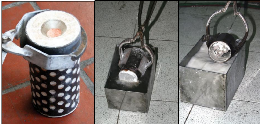
Figura 62. Forma de tomar el cilindro, choque térmico y desprendimiento del revestimiento. Fuente: Datos referencia 2.
