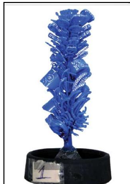
Figura 47. Árbol de reproducciones en cera. Fuente: Datos referencia 2.
