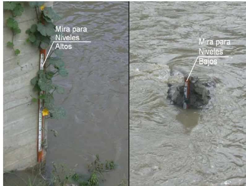
Foto 3. Estación limnimetrica después del 12/02/2005, Café Madrid
