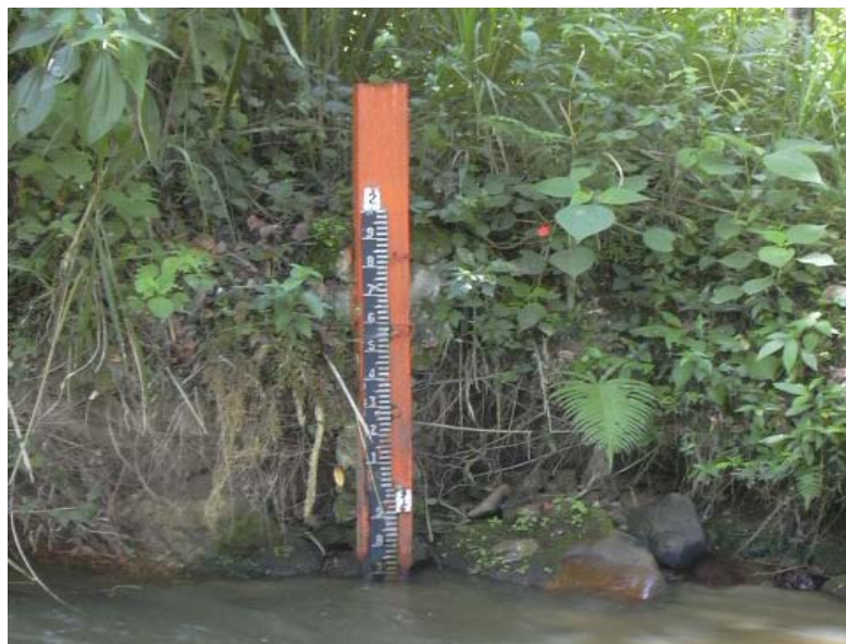
Foto 5. Estación Limnimetrica (mira), El Conquistador
