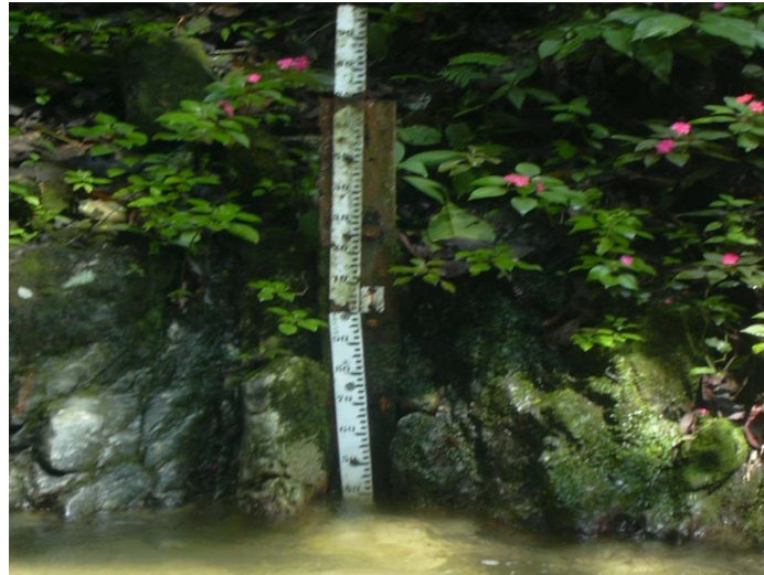
Foto 7. Estación limnimetrica (mira), La Esperanza
