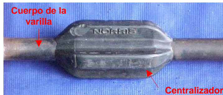
Figura 12. Fotografía de un centralizador ubicado sobre el cuerpo de una varilla.
