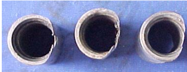
Figura 4. Sección transversal de acople fuera de servicio.
