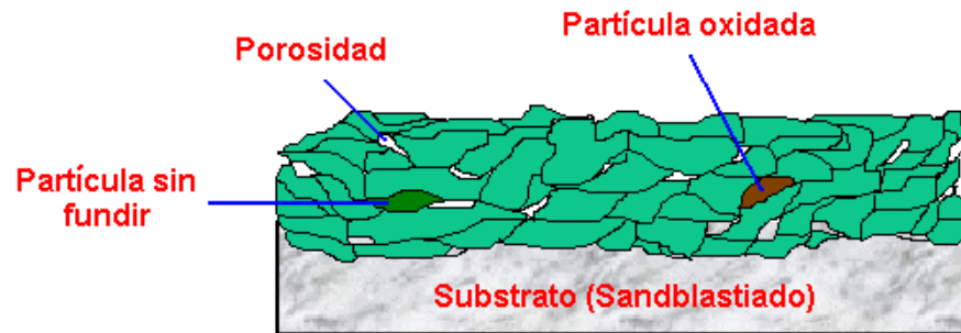
Figura 11. Sección transversal de una superficie recubierta por termorrociado.
