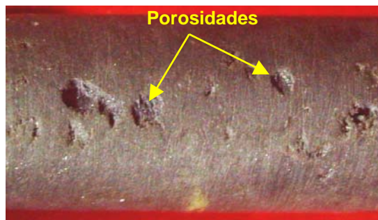
Figura 58. Presencia de porosidades en el material de centralizador, 75X.
