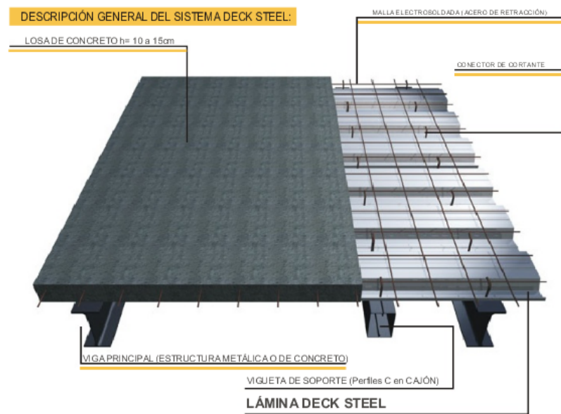
Figura 8 : Descripción del sistema tradicional con “Steel Deck” 15
