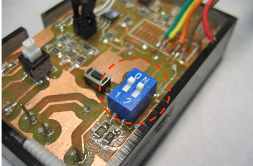
Figura 7: Interruptores para la posición del sensor
