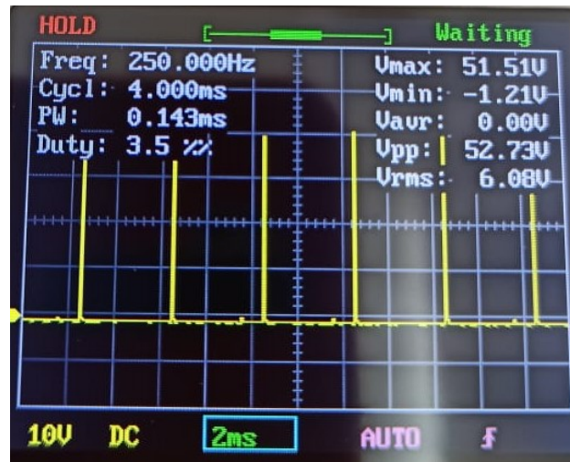
Figura 61. Resultado implementación con impedancia de carga R = 10[\text{k}\Omega] y C = 0.1 [\text{uF}]
