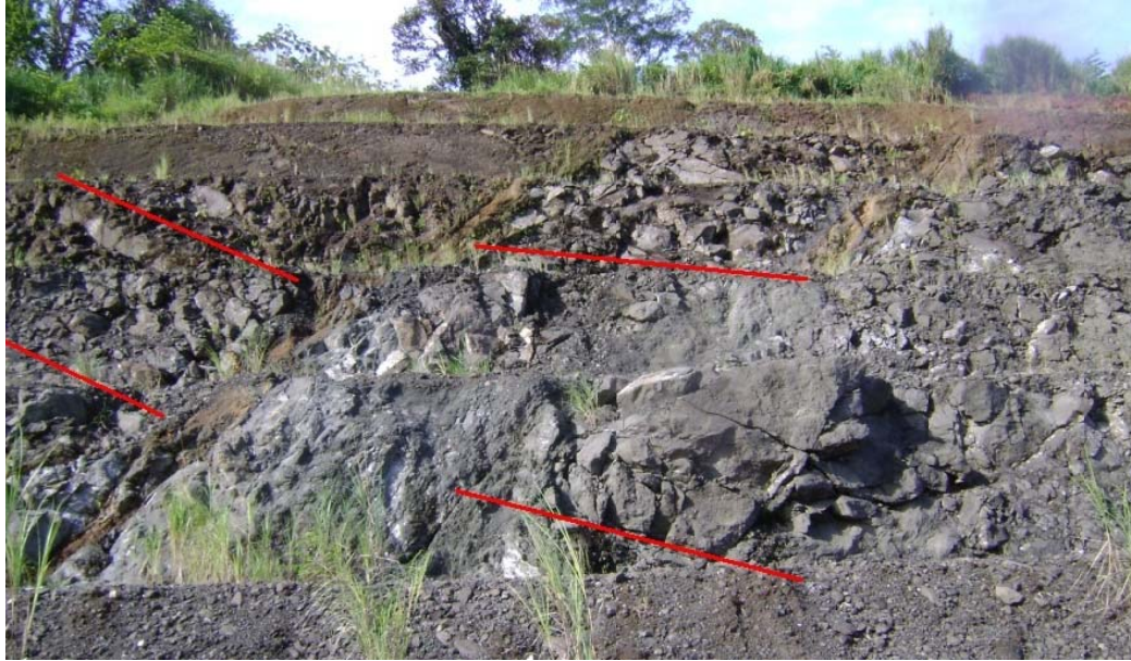
FIGURA 6.4: Afloramiento 4 de la formación Bas Obispo, se señalan los planos de estratificación observados en las tobas.
