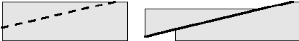
FIGURA 4.8: Fallas normales de bajo ángulo, modificado de Martínez 2003
