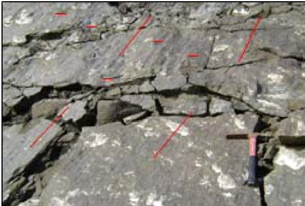
FIGURA 3.3: Lineaciones observadas en campo, las cuales se midieron durante la investigación realizada.
