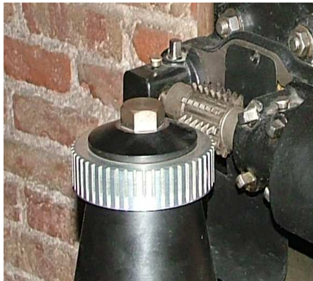
Figura 52. Fresado convencional versus fresa madre.
