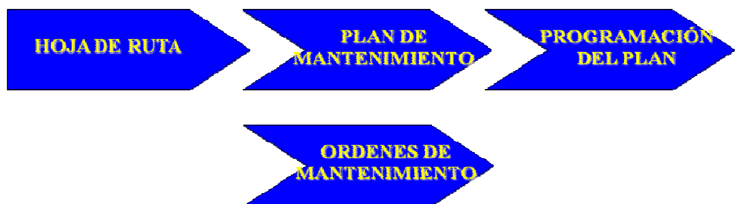
Figura 25. Ciclo de mantenimiento preventivo
