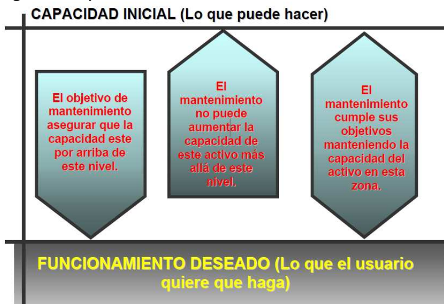
Figura 6. Capacidad de funcionamiento de los activos.
