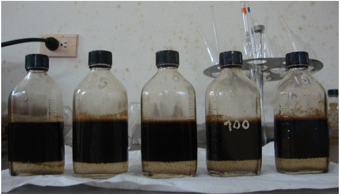
Figura 29. Prueba de Botella a Temperatura Ambiente en el Laboratorio
