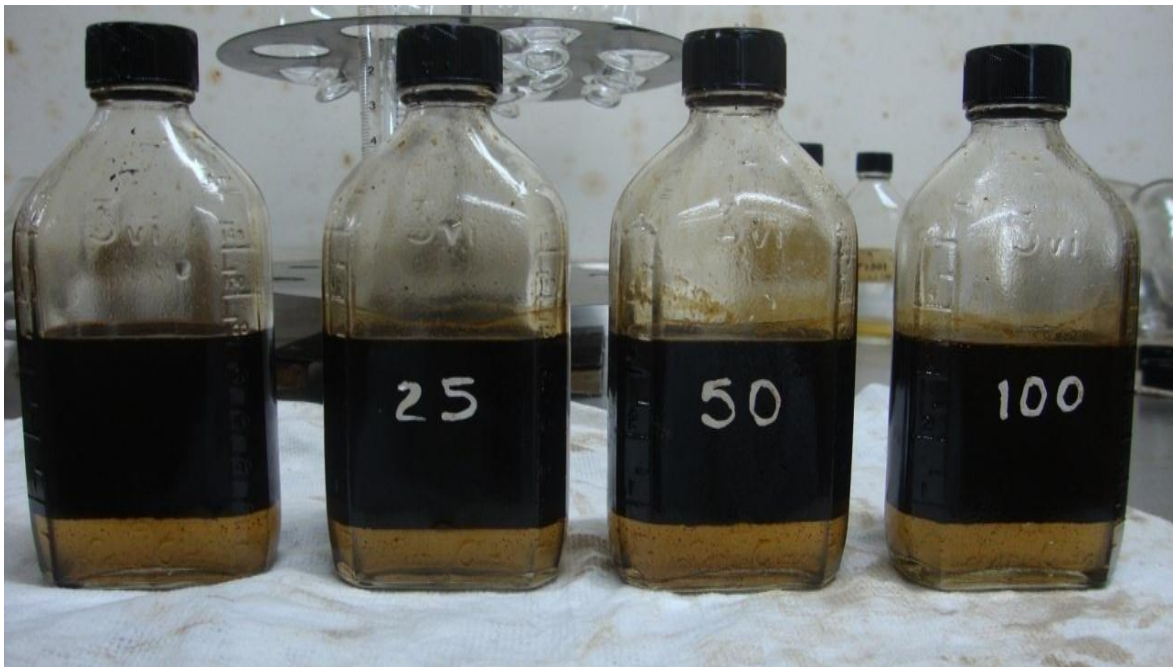
Figura 31. Prueba de Botella a 140 °F de Temperatura en el Laboratorio
