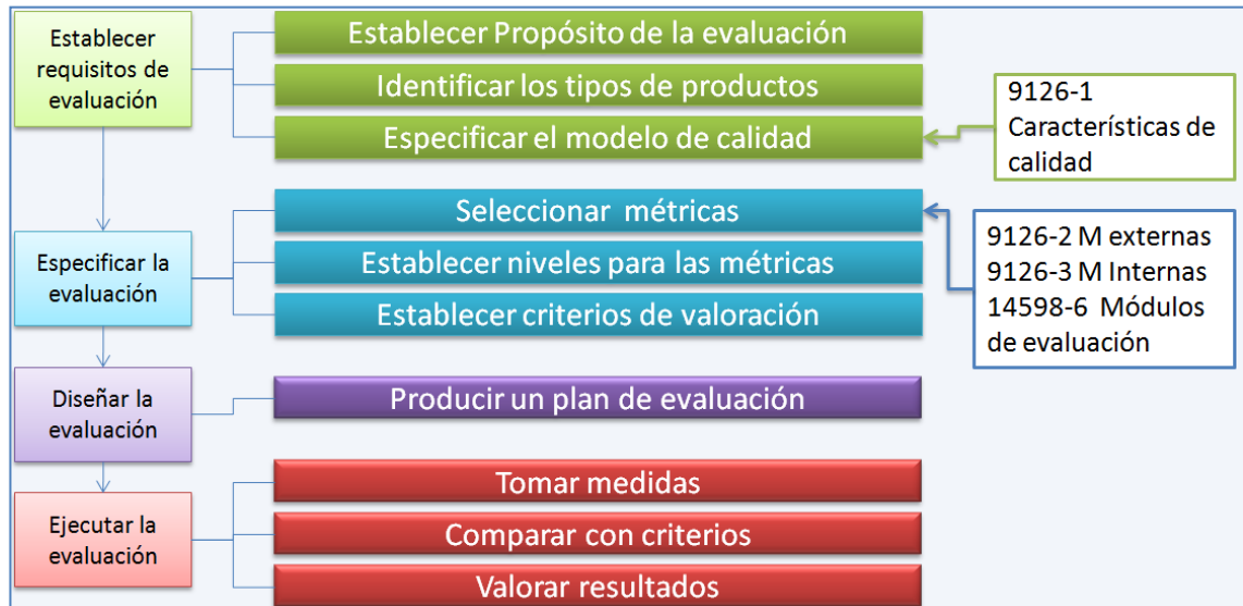
Figura 5: Proceso de evaluación de un producto software
