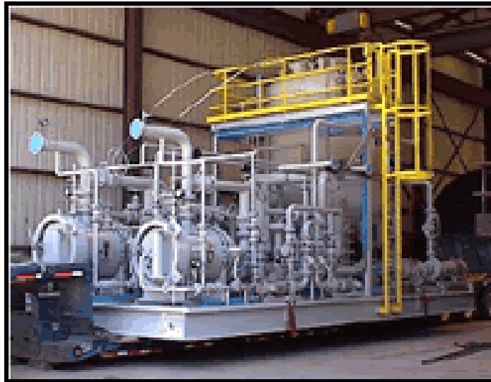
Figura 18. Hidrociclón Líquido/Líquido marca Vortoil ®
