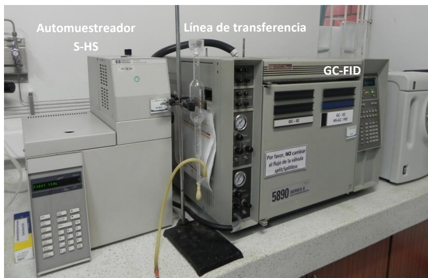
Figura 76. Automuestreador de espacio de cabeza, Headspace Sampler Hewlett Packard 7694E, acoplado a un cromatógrafo de gases GC-FID: Hewlett Packard 5890 Series II
