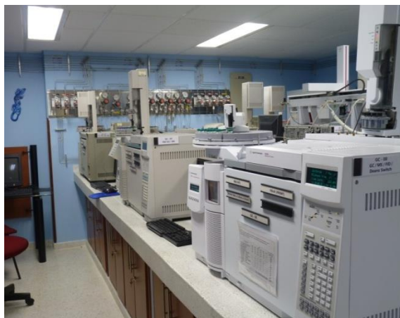
Figura 14. Cromatógrafos de gases con diferentes sistemas de detección empleados en la caracterización química de los aceites esenciales. Laboratorio de Cromatografía y Espectrometría de Masas – CROM-MASS – CIBIMNOL – UIS.
