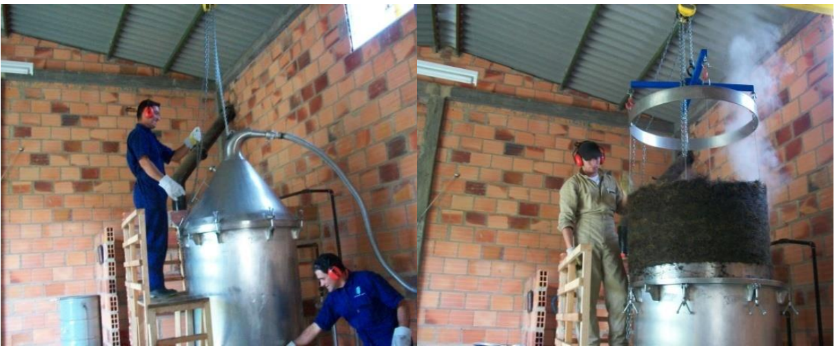
Figura 13. Proceso de extracción de aceites esenciales por el método de arrastre con vapor. Vereda el Retiro, Municipio de Sucre, Santander, agosto de 2011.
