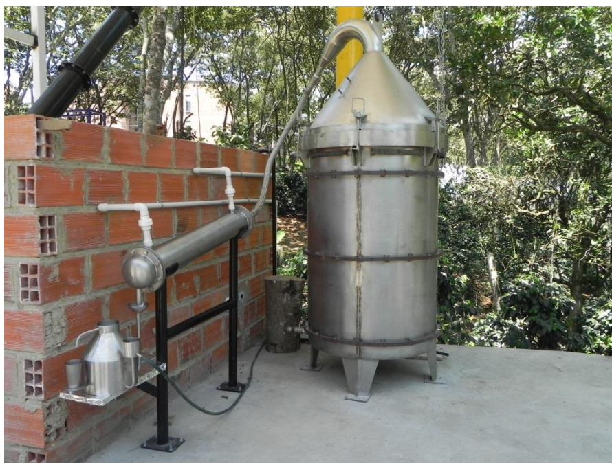
Figura 31. Planta de extracción de AE, instalada y puesta en marcha en el municipio de Barbosa (Santander). Foto: Camilo Durán, Febrero de 2015.
