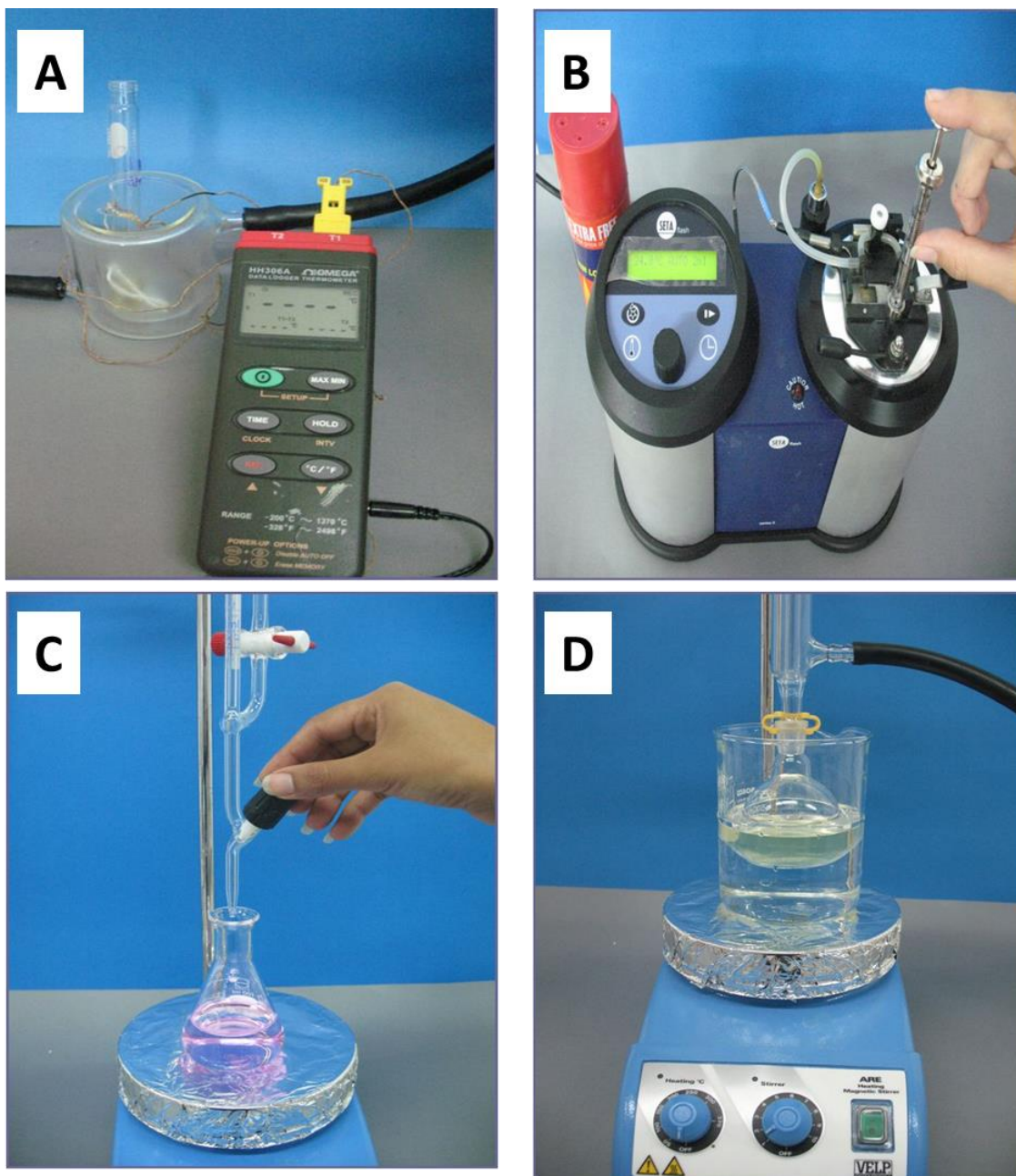
Figura 27. Equipos y montajes empleados durante la determinación de las propiedades fisicoquímicas de AE, según las normas internacionales ISO. A. Data logger/thermometer HH306A, Omega (norma ISO 1041). B. SetaFlash Tester Series 3 , con copa cerrada (Norma ISO 11018). C. Bureta doble clase A, BRAND, (Norma ISO 1242). D. Bureta clase B (BRAND), frascos de saponificación de 100 mL (Norma ISO 709). Fotografías Andrea Agudelo. CIBIMOL CENIVAM-2012.
