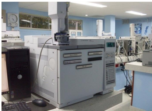
Figura 26. Cromatógrafo de gases de alta resolución Agilent Technologies 6890N, con detector de ionización en llama (FID). Foto: Camilo Durán, Laboratorios CIBIMOL-CENIVAM.
