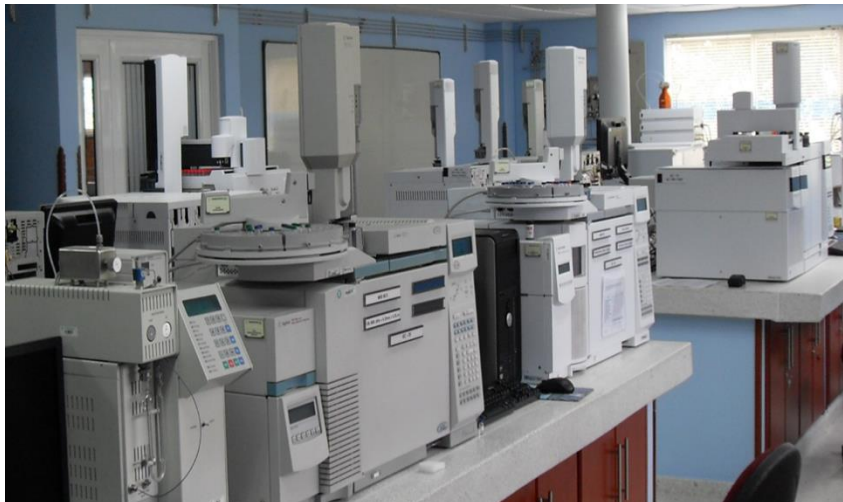
Figura 25. Cromatógrafos de gases Agilent Technologies 6890 Plus Series y 7890 GC System acoplados a detectores selectivos de masas Agilent Technologies 5973 Network y 5975C, equipados con un puertos de inyección split/splitless y un inyector automático Agilent 6890. Foto: Camilo Durán, Laboratorios CIBIMOL-CENIVAM, octubre 2014.
