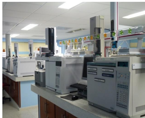
Figura 14. Cromatógrafos de gases con diferentes sistemas de detección empleados en la caracterización química de los aceites esenciales. Laboratorio de Cromatografía y Espectrometría de Masas – CROM-MASS – CIBIMNOL – UIS.
