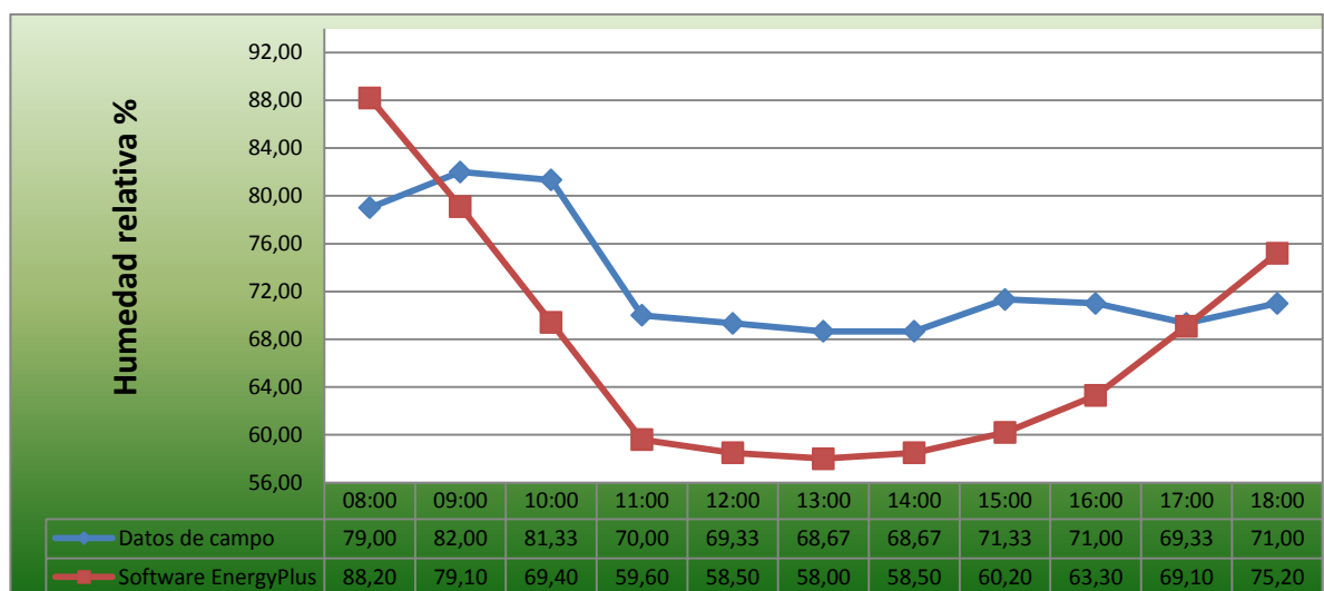
Figura 51. Comportamiento humedad relativa zona auditorio
