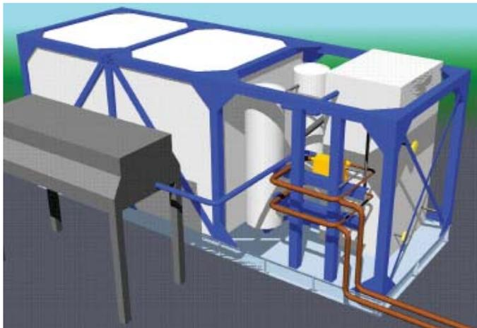
Esta mini-planta de GNL es tanto energéticamente como en costos optimizados. Es una planta modular, con pretratamiento, motor a gas, almacenamiento y Terminal de carga a camiones. El ahorro de costos y la rapidez en el ensamblaje se ve reflejado por la utilización de equipos estándar. Es además una planta móvil, con capacidad variable y con ciclo de refrigerantes mezclados para un consumo de energía óptimo.
