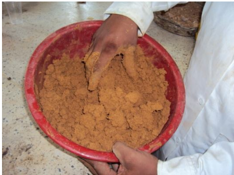
Figura 45. Mezcla de agua y muestra de suelo.
