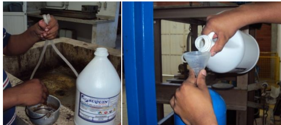
Figura 51. Llenado de las líneas y el tanque de presión.
