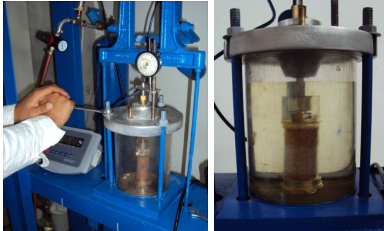
Figura 53. Adecuacion y confinamiento en la camara.
