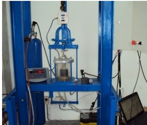
Figura 39. Pruebas de calibración en el equipo Soiltest.
