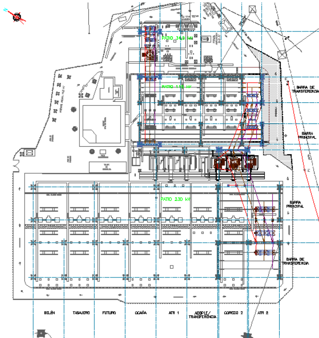
Figura 56. Propuesta alternativa 3 para la ampliación de la SE San Mateo
