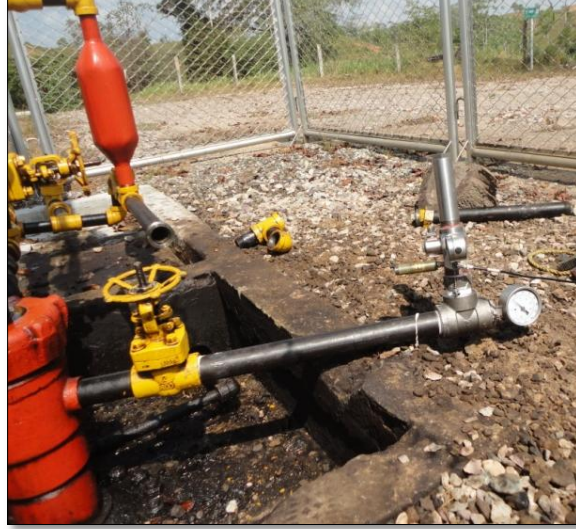
Figura 30. Conexión de la pistola al anular del pozo.
