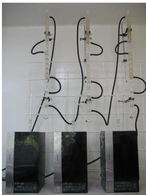
Figura 8. Montaje para la hidrodestilación asistida por la radiación de microondas (MWHD). Fotografía tomada por la autora. Lugar: CENIVAM, UIS. Fecha: Febrero de 2012.
