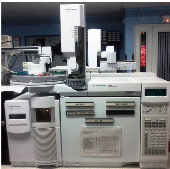
Figura 10. Cromatógrafo de gases Agilent Technologies 6890 Plus , acoplado a un detector selectivo de masas Agilent Technologies MSD 5975 Network . Fotografía tomada la autora. Lugar: Laboratorio de Instrumentación Analítica CENIVAM, UIS. Fecha: Agosto de 2012.
