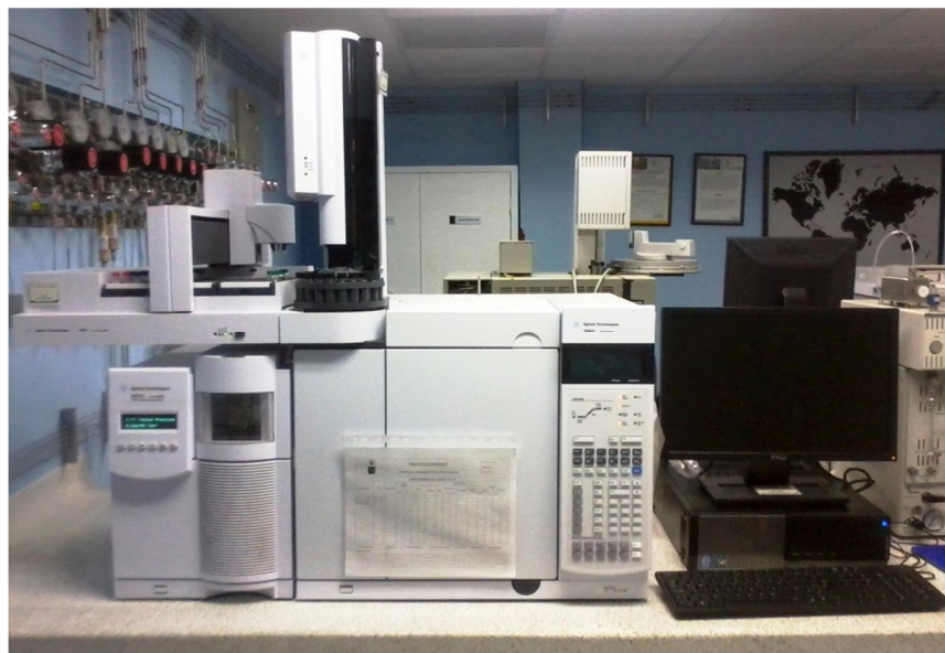
Figura 9. Cromatógrafo de gases Agilent Technologies 6890N Network, Series GC , acoplado a un detector selectivo de masas Agilent Technologies 5975 Inert XL . Fotografía tomada por la autora. Lugar: Laboratorio de Instrumentación Analítica CENIVAM, UIS. Fecha: Agosto de 2012.
