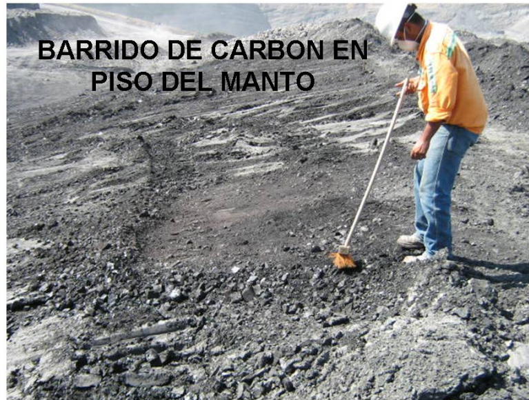
Figura 67. Barrido con escoba industrial en piso del manto 270.
