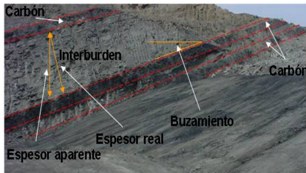
Figura 9. Paredes laterales que quedan expuestas en avance.
