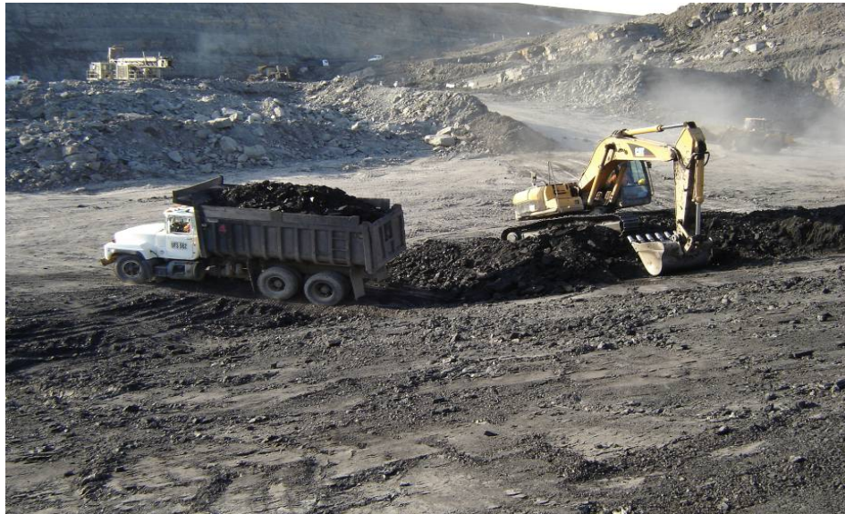
Figura 39. Recuperación del piso del manto barriendo con cucharón. Fuente. C.I Prodeco S.A.
