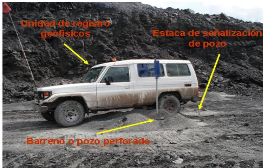
Figura 58. Registro de área de voladura bajo manto.
