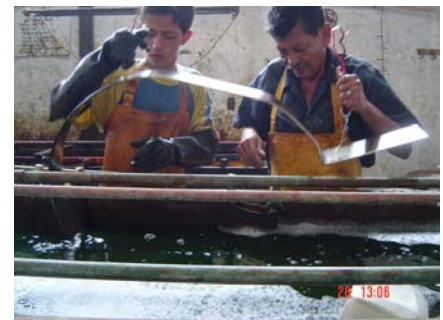
Figura N. 49. 1ro. La pieza es introducida en sulfato de Níquel.
