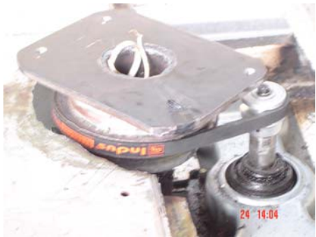
Figura N. 61. Poleas y bandas superiores. Freno de seguridad para el motor.
