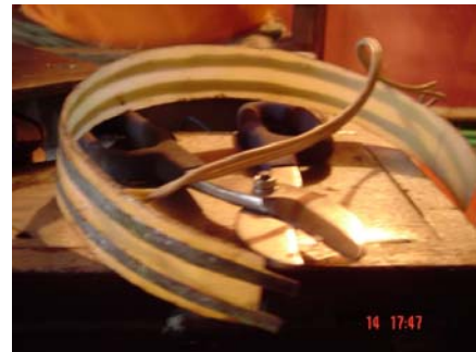
Figura N. 63. Tiras de metal para los contactos. Colocación de las tiras de metal en el aislante plástico.
