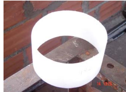
Figura N. 62. Plástico como aislante del contacto eléctrico
