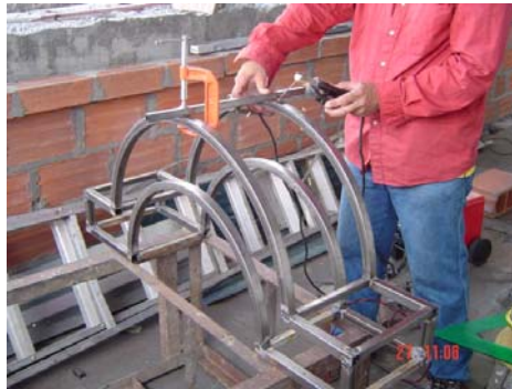
Figura N. 46. Hierro soldado para la estructura.
