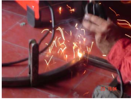
Figura N. 45. Acoplamiento de los tubos. Soldadura.
