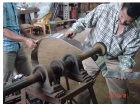
Figura N. 52. 4to. Por último, se lava nuevamente la pieza y se pule para darle la textura lisa deseada.
