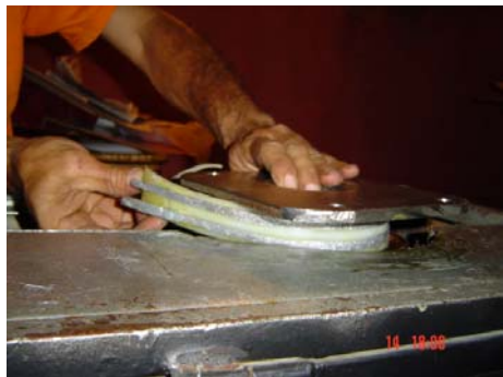
Figura N. 64. Colocación de las tiras de contacto en el rodillo giratorio. Escobillas de contacto en la estructura fija.
