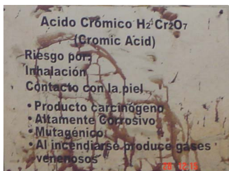
Figura N. 51. 3ro. Se sumerge en Ácido Crómico. En este tanque se produce una reacción del ácido activada por corriente eléctrica a través del agua.
