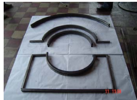
Figura N. 44. Corte hierros rectangulares y arcos terminados.
