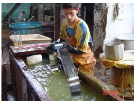
Figura N. 52. 4to. Por último, se lava nuevamente la pieza y se pule para darle la textura lisa deseada.
