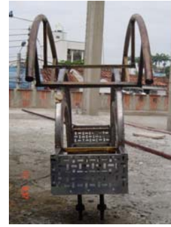
Figura N. 54. Pieza superior con hierro oxidado, lámina inoxidable, Lámina corrugada y tornillos de 15 cm. de largo con tuercas.
