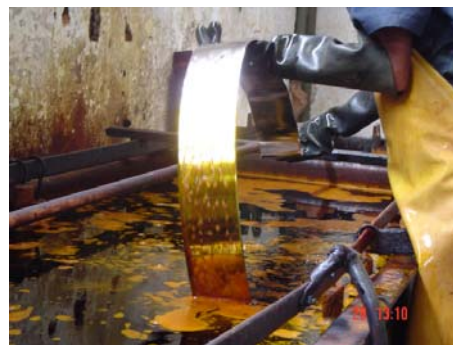
Figura N. 51. 3ro. Se sumerge en Ácido Crómico. En este tanque se produce una reacción del ácido activada por corriente eléctrica a través del agua.
