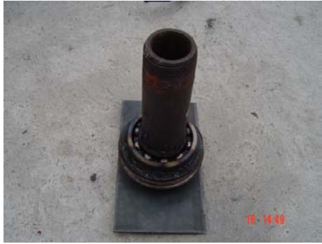
Figura N.60. Eje central con rodamiento, sostiene el peso de la estructura. Instalación del motor interno. (Maquinaria usada y reciclada)
