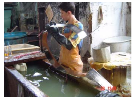
Figura N. 50. 2do. Se lava para retirarle los residuos del ácido.
