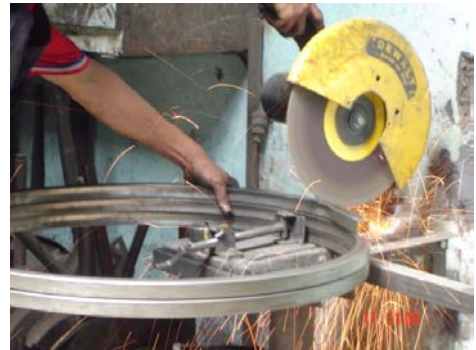
Figura N. 43. Corte de los arcos sobre medidas
