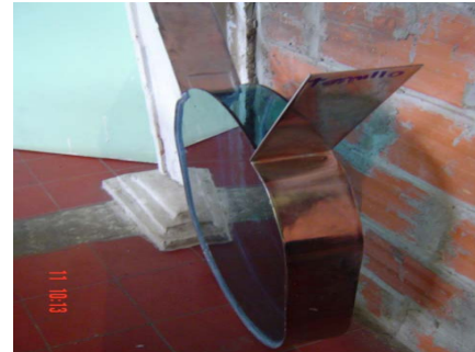
Figura N. 55. Pieza inferior: "Mueble metálico desechado" acoplado como soporte para el motor. Pieza central: Contenedor de peces.
