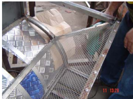
Figura N. 58. Para la adherencia de la resina se utilizó una malla zaranda. Y Resina color gris.
