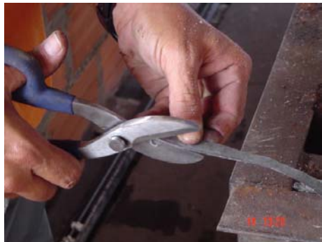
Figura N. 63. Tiras de metal para los contactos. Colocación de las tiras de metal en el aislante plástico.
