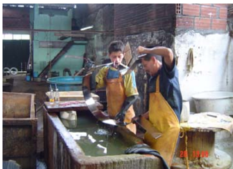
Figura N. 50. 2do. Se lava para retirarle los residuos del ácido.
