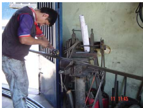
Figura N. 44. Corte hierros rectangulares y arcos terminados.
