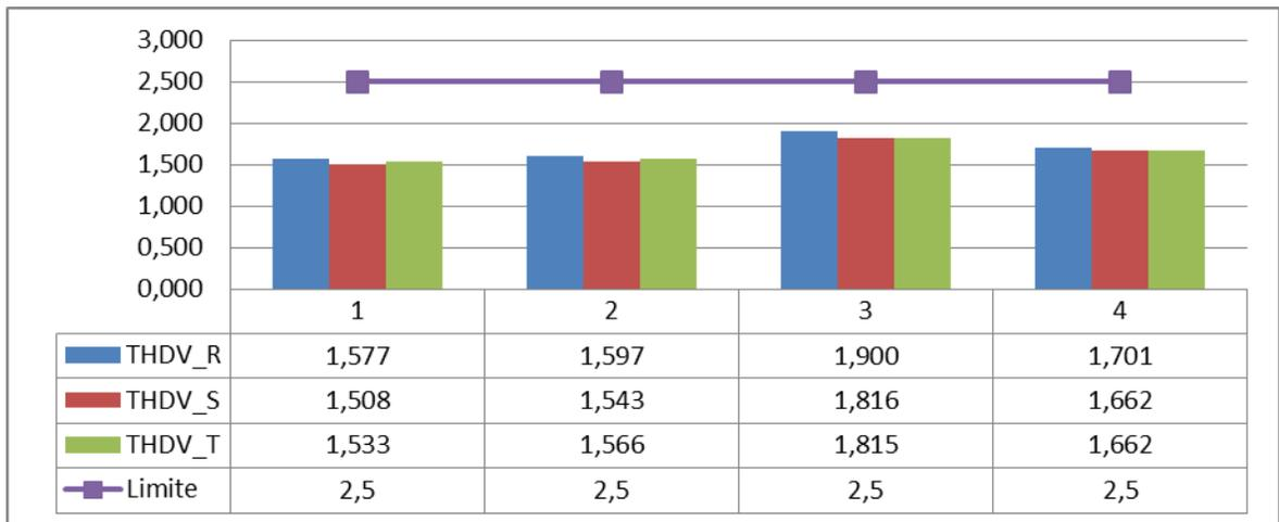
Figura 3.10 Evaluación del indicador HDV en la S/E Puerto Wilches 115 kV.
