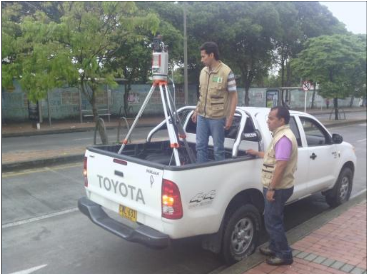
Figura 39. Levantamiento de la información con el Escáner Láser Terrestre montado sobre una camioneta
