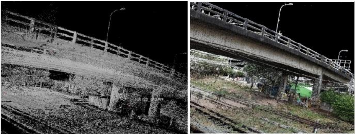
Figura 7. a) Nube de puntos cruda. b) Nube de puntos con textura
