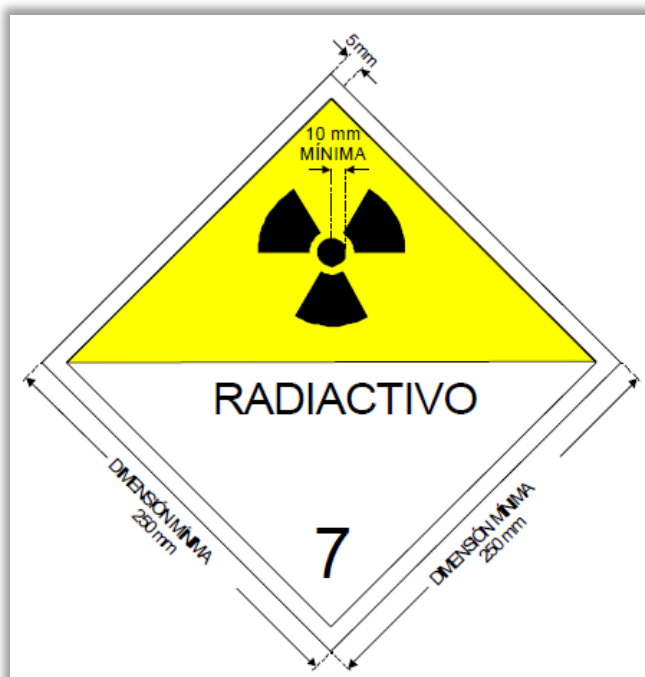
Figura 21 – Señalización Radiactividad Vehículo.
