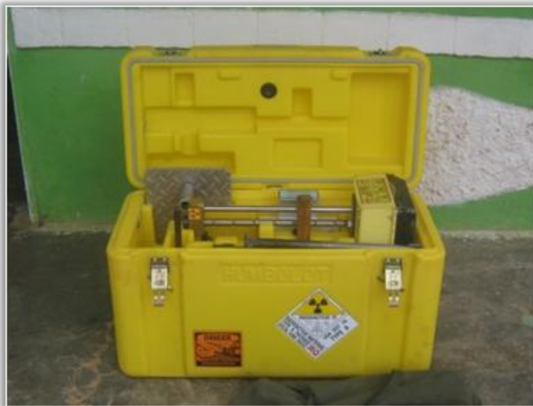
Figura 20 – Señalización Final Bulto
