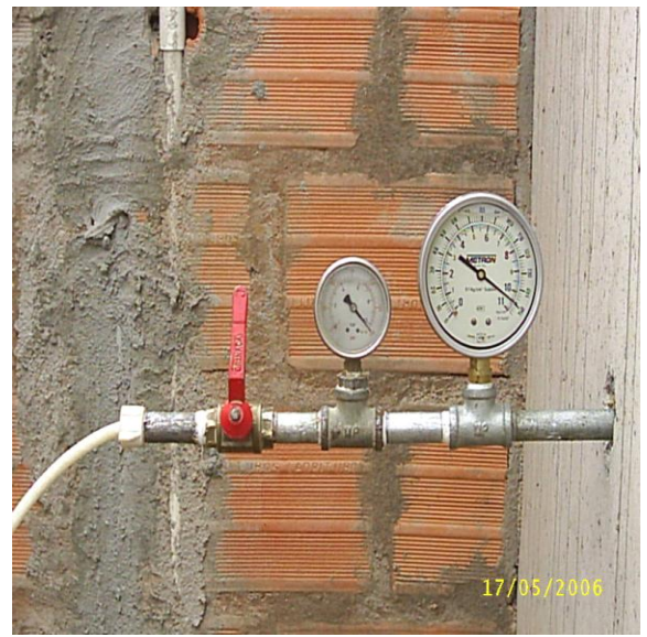
Figura 6 – Calibración de manómetros
