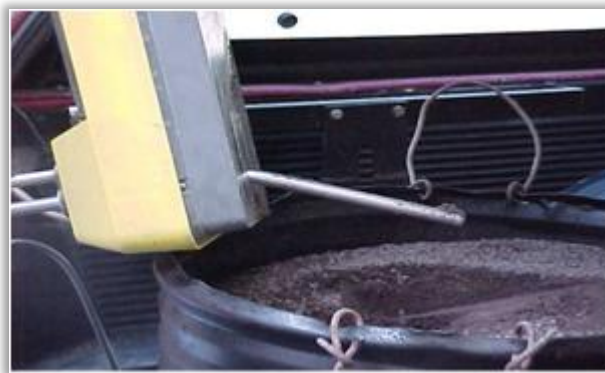
Figura 35 – Daño del densímetro y fuga de Cesio-137
