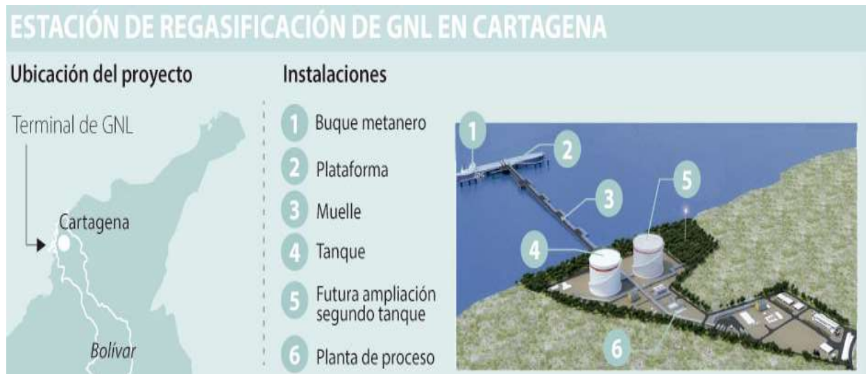
Figura 22. Vista general de la estación de regasificación de GNL costa caribe Colombia.
