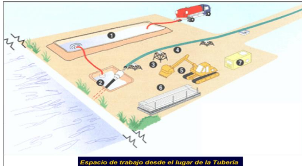
Figura 25. Esquema típico de la plataforma de construcción de la lingada.
