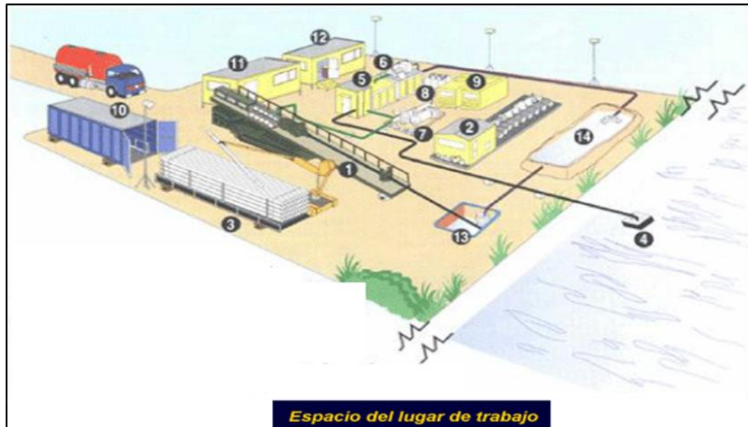
Figura 24. Esquema típico de la plataforma principal.
