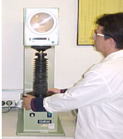
Figura 12. Durómetro para realizar ensayos de dureza Brinell y Vickers
