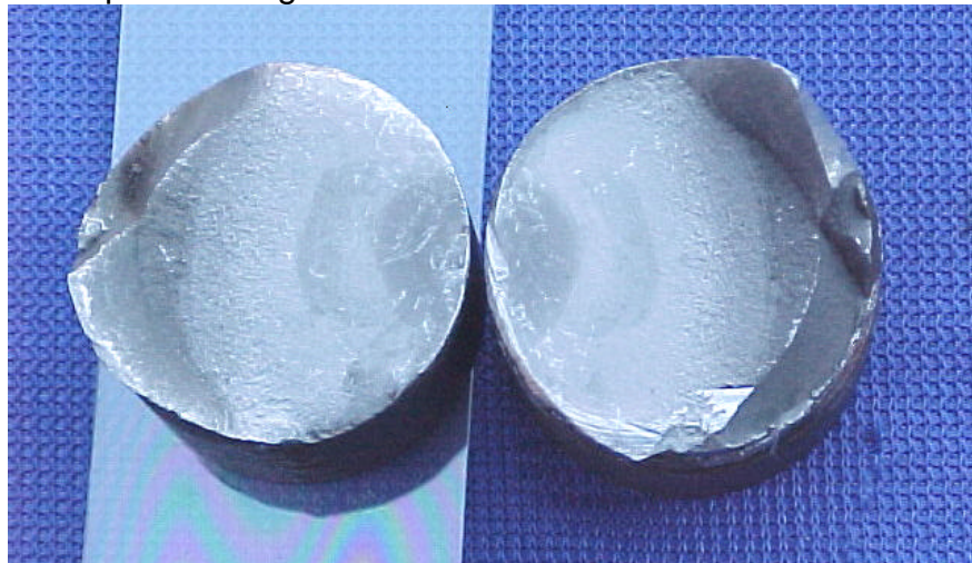
Figura 3. Falla típica de fatiga.
