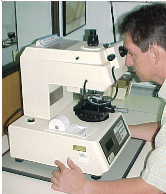
Figura 13. Equipo para realizar mediciones de microdureza Vickers.
