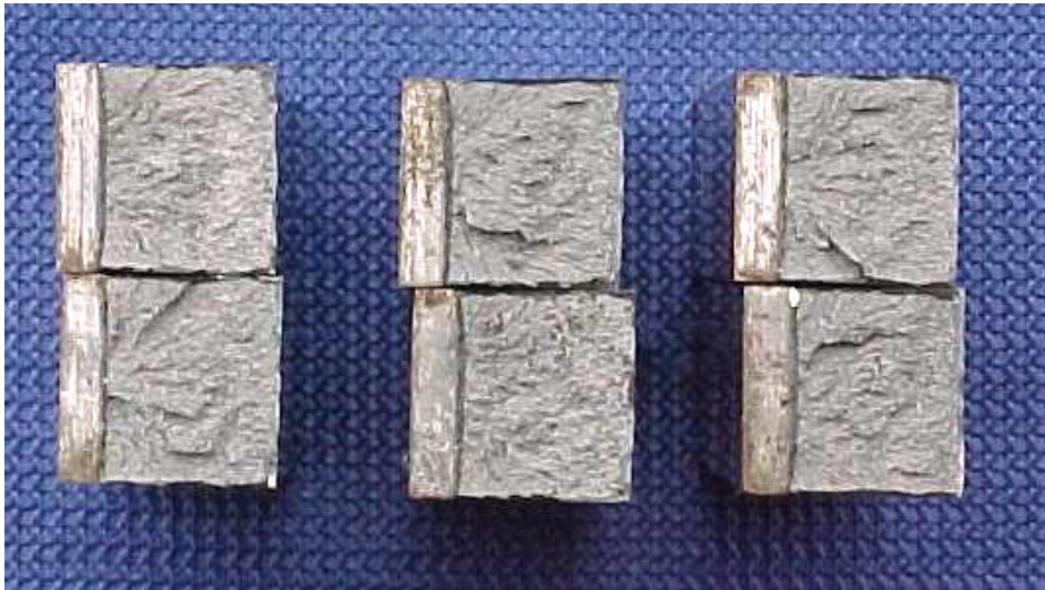
Figura 45. Superficies de fracturas para la muestra F1-M4
