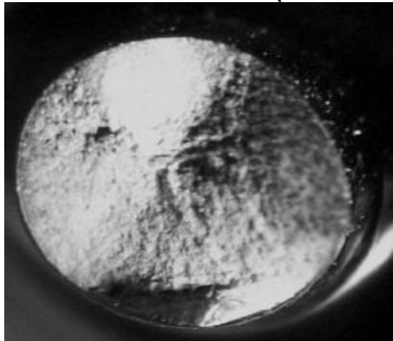
Figura 65. Superficie de fractura muestra F3-M3 ( 372.33 MPa, 223396 ciclos )
