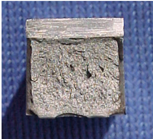
(b). Probeta con (20%) de fractura por corte.
