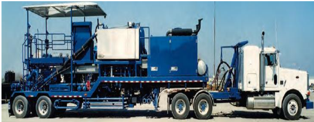
Figura 14. Unidad de Cementación sobre remolque
