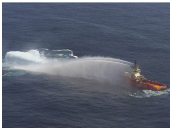
Figura 48 Cañones de Agua
