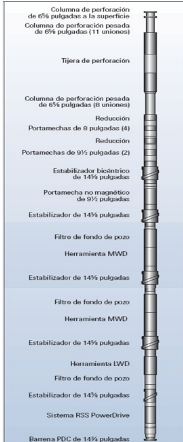
Figura 91 Arreglo de fondo del pozo para perforar un cuerpo salino
