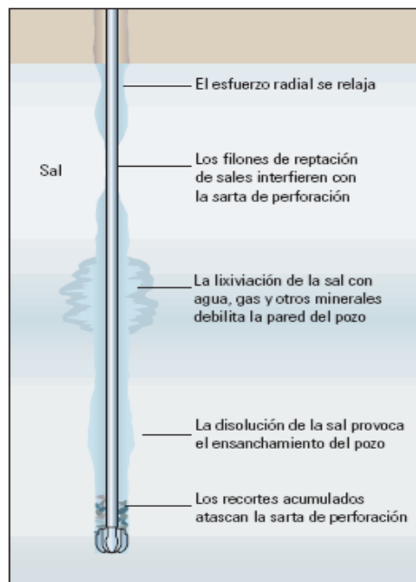
Figura 87 Problemas potenciales presentes en la perforación del domo salino.
