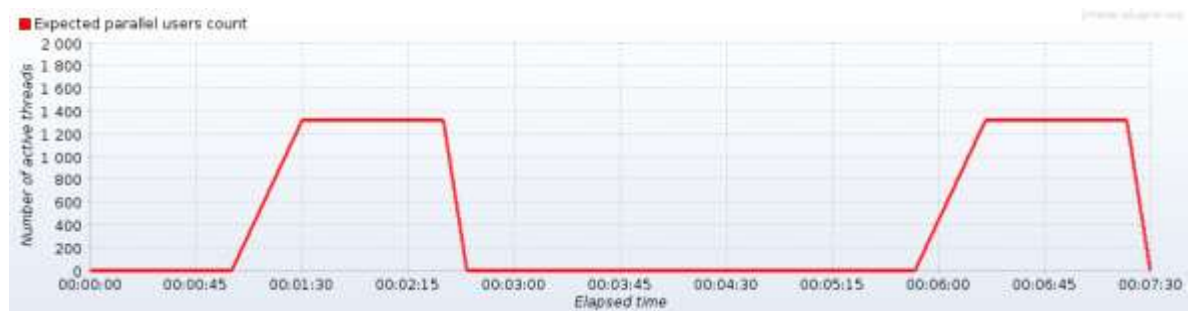
Figura 18. Representación de la prueba de estrés (spike) de Vert.x.
