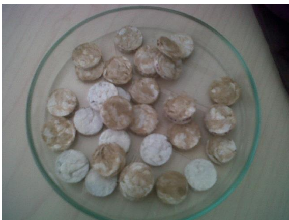
Ilustración 58 Pastillas de fibra con diferentes porcentajes de materiales.
