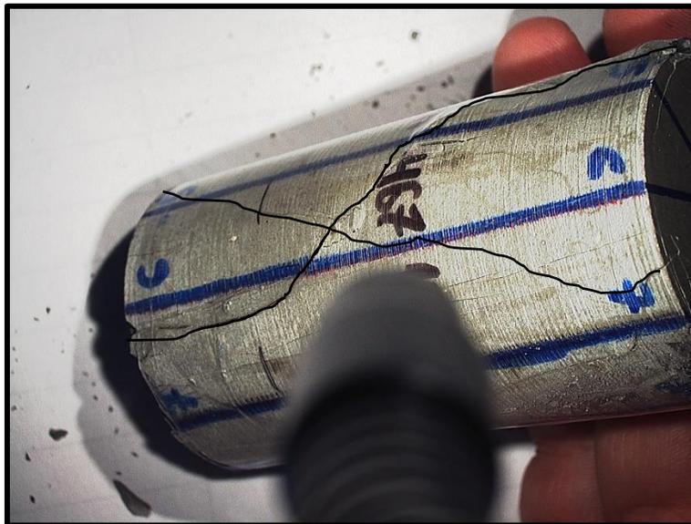
Figura 37. Falla por cizalla muestra convencional 1.5% Bentonita ID 201146710
