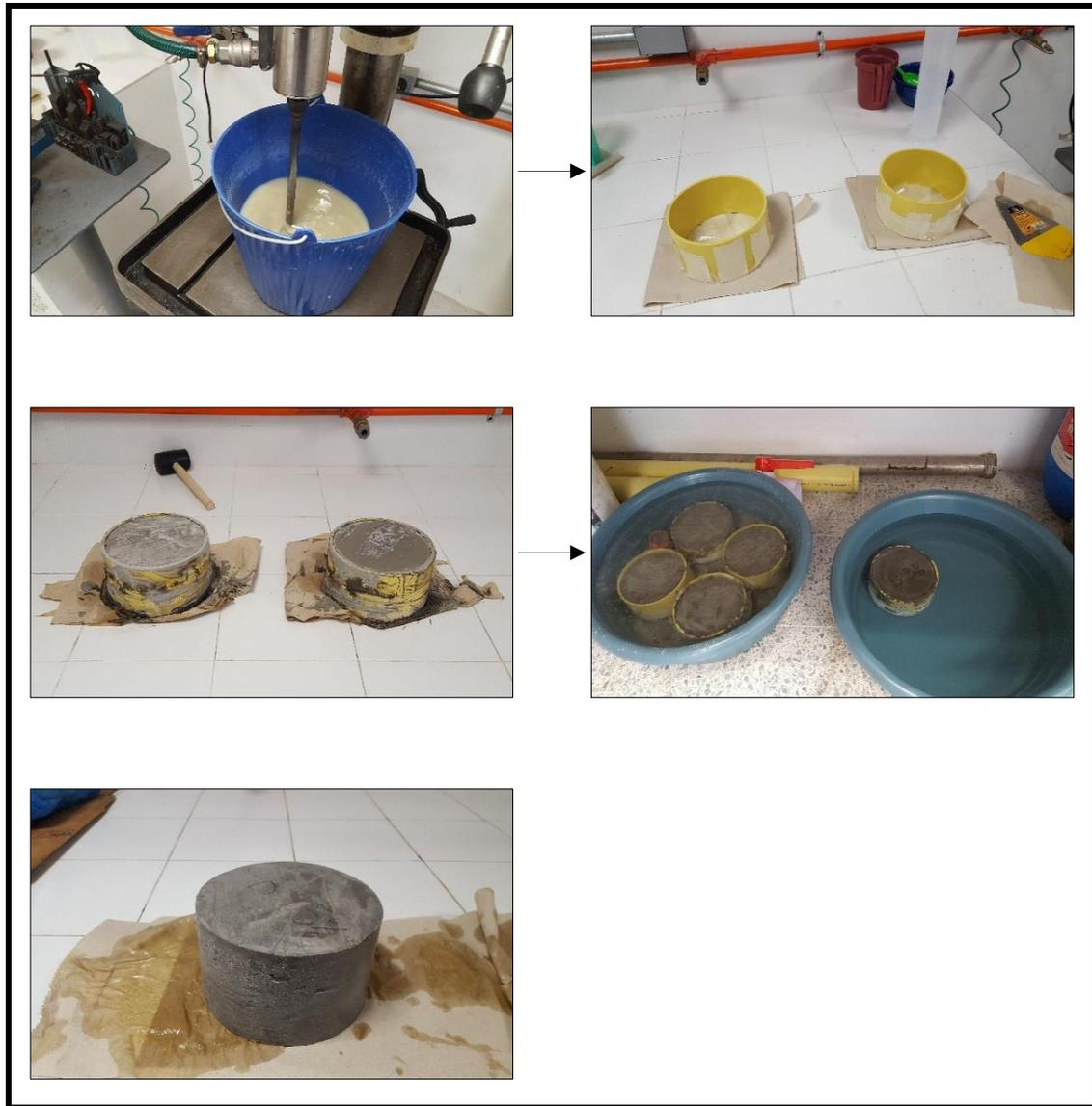
*Figura 23. Mezclado y fraguado de las muestras*
