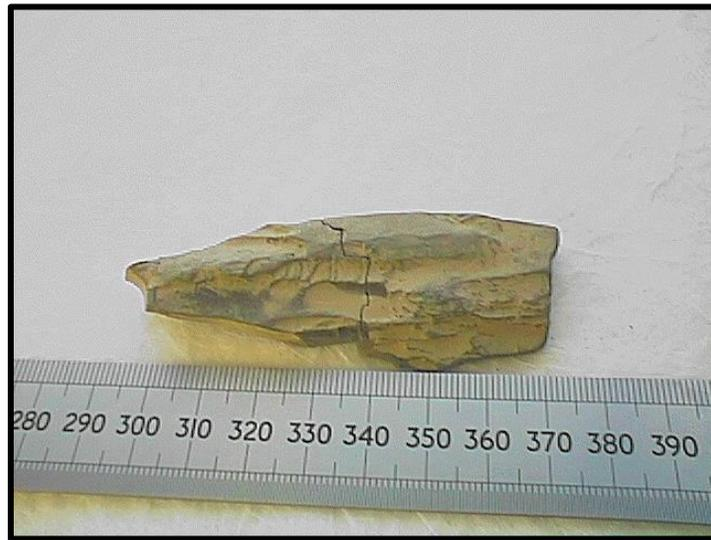
*Figura 5. Forma de un caving angular (Tomado de Bradford et al., 2000)*
