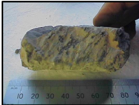
*Figura 4. Forma de un caving tabular (Tomado de Bradford et al., 2000)*
