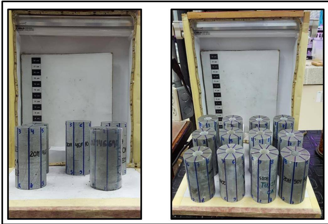
Figura 25. Muestras con Bentonita al 1.5%
